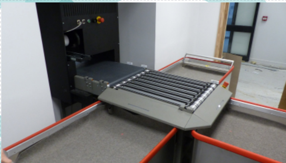
La borne de retour est équipée d'un système de tri automatisé.
